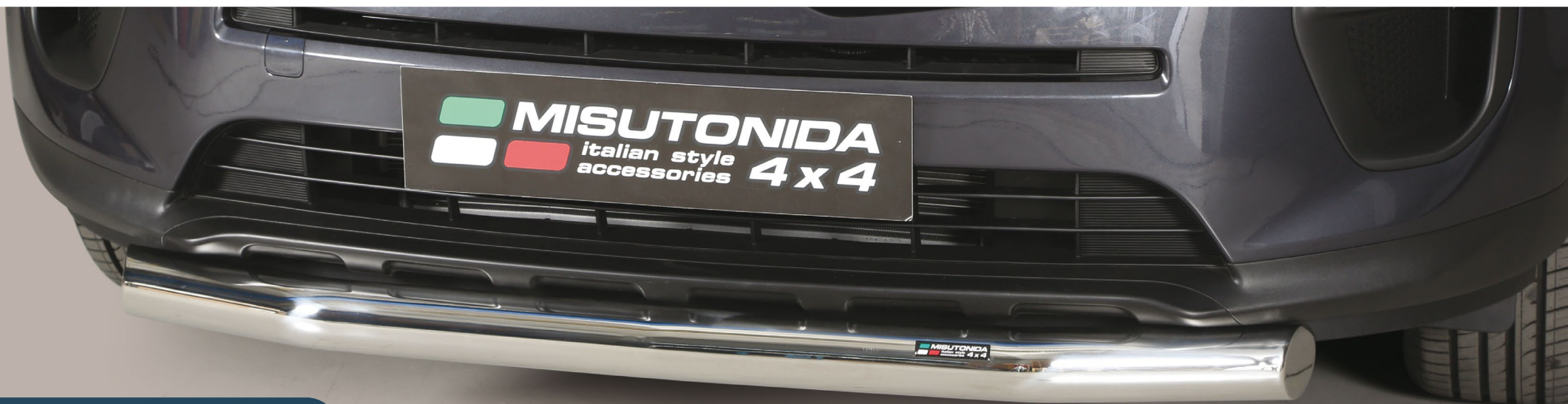
SLF/403/IX Slash Front Protection Ø 76mm
